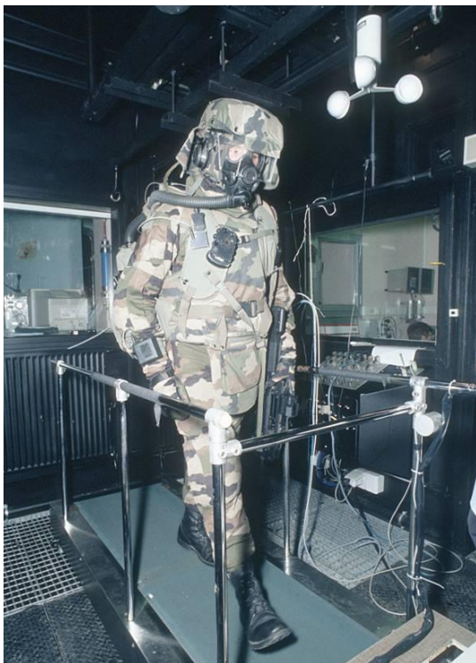
Figure 32. Test du port d'une combinaison NRBC dans le module « chaud ». Coll. Privé, CRSSA, F. Dorandeu, Année 2000.
